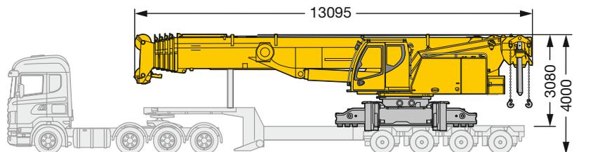
Transportbreite 3 m bei Tieflader bis 2,55 m Breite
