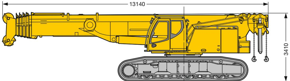
Grundgerät, Breite 3000 mm, mit Jack-Up Zylinder (Option)
