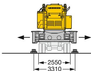
Ausklappen der 4 Jack-Up Zylinder
